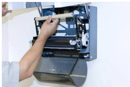
4. Plaats de houten rol terug in de automaat en open de zwarte (tractie) rol door hem naar voren te halen.
