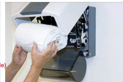
3. Druk de vuile rol naar boven dmv de houten rol en verwijder de rol.
